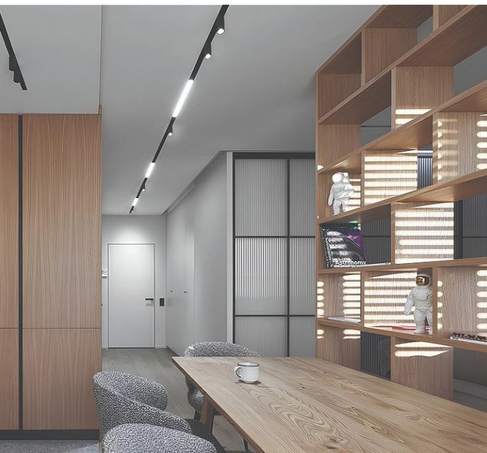
Светильники для магнитной трековой низковольтной системы применяются для акцентного освещения в квартирах, загородных домах, офисах. Светильники работают от 48В. Для работы светильников, к шинопроводу необходимо подключать блок питания LB48,048.
